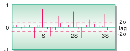
Figur 10 Teoretisk form på autokorrelasjonsfunksjonen for ikke-stasjonære tidsrekker. Spesielle tilfeller
